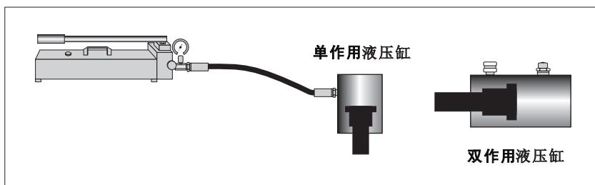
单作用液压缸：将液压缸倒置，底部朝上活塞杆朝下，并且使之底于油泵的位置，油泵供油，使之活塞杆完全伸出和收缩2-3次。
